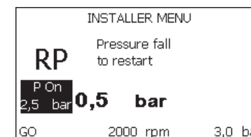
Рисунок 17: Настройка давления нового включения
