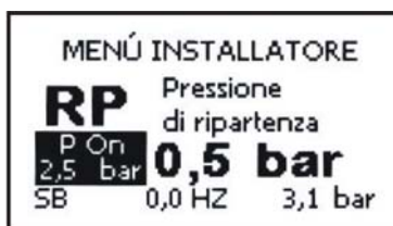
Рисунок 16: Настройка давления нового включения
